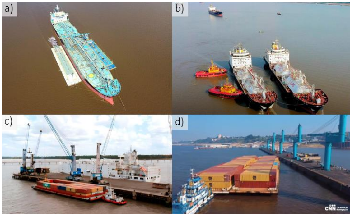
Figura 6. Operações de transbordo de cargas em período de vazante do rio Amazonas: a) navio de transportes de derivados de petróleo realizando o transbordo de carga líquida para a balsa ( ship to barge ); b) operação de transbordo de Gás Liquefeito de Petróleo-GLP entre navios gaseiros ( ship to ship ) na cidade de Itacoatiara; c) operação ship to barge nas proximidades da cidade de Itacoatiara; d) operação de transportes de contêineres entre Vila do Conde (PA) e a cidade de Manaus (AM). Fonte: Grupo Chibatão (2023); CNN (2023); (PORTOS E NAVIOS, 06/11/2023).
