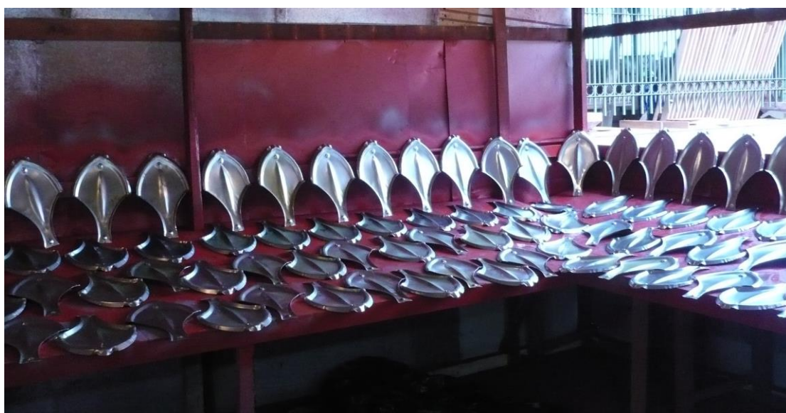
Figura 14: Pequena oficina no canteiro de obras, para estamparia das telhas escamadas em metal
